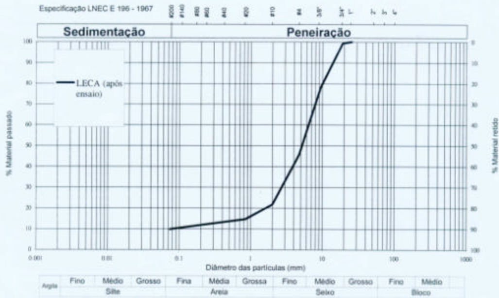
Fig. 1 - Curva granulométrica após a fase de corte do provete 3
